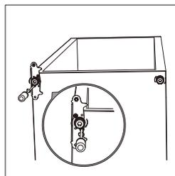
11. Plaats de deur terug. Zorg dat de deur horizontaal en verticaal is uitgelijnd, zodat de afdichtingen aan alle kanten sluiten voordat u ten slotte het bovenste scharnier vastdraait.
