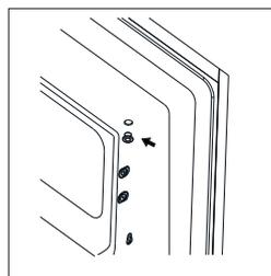
7. Drehen Sie die Gefrierfachtür, so dass die Scharnierseite links ist. Bringen Sie dann den Türhalter an.
