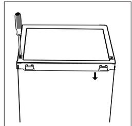
13. Entfernen Sie die Dichtungen von Kühlschrank- und Gefrierfachtür, drehen Sie sie, und bringen Sie sie dann wieder an.
