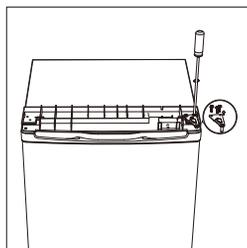
4. Schroef het onderste scharnier los. Verwijder de stelvoetjes aan beide kanten.
