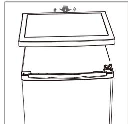
3. Schrauben Sie nun das obere Scharnier los, heben Sie die Tür ab und legen Sie sie auf einer gepolsterten Fläche ab, um Kratzer zu vermeiden.
