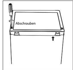
2. Entfernen Sie die obere Abdeckung und legen Sie sie beiseite.
