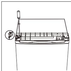
12. Placez le couvercle supérieur et fixez-le avec 2 vis à l'arrière.
