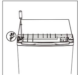
12. Setzen Sie obere Abdeckung ein und befestigen Sie diese mit 2 Schrauben.
