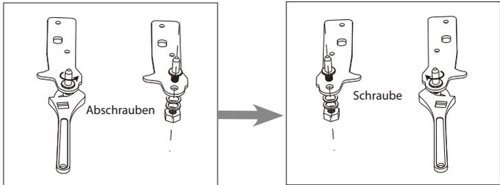
10. Setzen Sie die Halterung wieder ein, indem Sie den unteren Scharnierstift montieren. Ersetzen Sie die beiden Verstellfüße.
