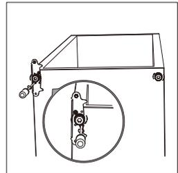
11. Setzen Sie die Tür erneut ein. Achten Sie darauf, die Tür horizontal und vertikal auszurichten, so dass die Dichtungen auf allen Seiten abschließen, bevor Sie das obere Scharnier endgültig befestigen.
