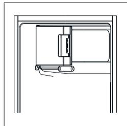
8. Schroef het onderste scharnier los. Verwijder de stelvoetjes aan beide kanten.
