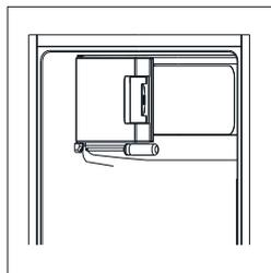
8. Schrauben Sie das untere Scharnier ab. Entfernen Sie anschließend die Stellfüße von beiden Seiten.
