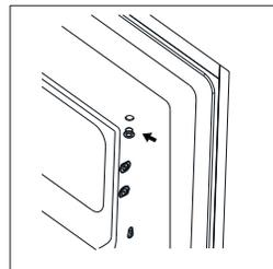
7. Draai de deur van de vriezer en plaats de scharnierzijde aan de linkerkant. En repareer dan de deur per houder.
