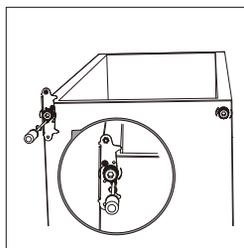
11. Remettez la porte. Assurez-vous que la porte est alignée horizontalement et verticalement, de sorte que les joints soient fermés de tous les côtés avant de serrer enfin la charnière supérieure.
