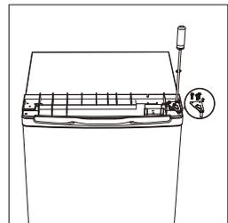
4. Schrauben Sie das untere Scharnier der Gefrierfachtür ab. Entfernen Sie dann die Tür und legen Sie sie auf einer weichen Unterlage ab, um Kratzer zu vermeiden.
