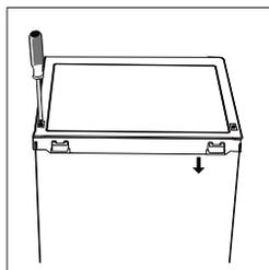
13. Maak de pakkingen van de koelkast en de deur van de vriezer los en bevestig ze na het draaien.
